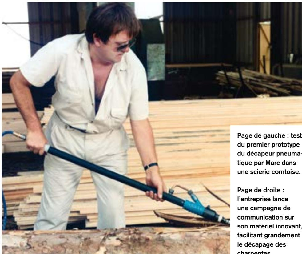
Page de gauche : test du premier prototype du décapeur pneumatique par Marc dans une scierie comtoise.
