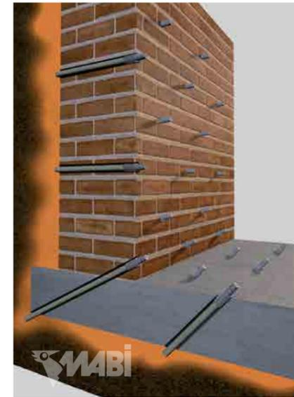
Der Dichtigkeits-Schirms erlaubt die Abdichtung von Mauern von außen ohne Ausschachtungen.
